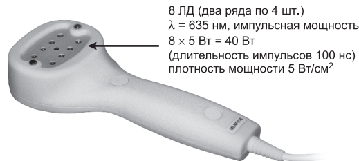
Рис. 3.5. Матричная лазерная излучающая головка МЛ-635-40
