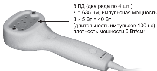
Рис. 10. Матричная лазерная излучающая головка МЛ-635-40
