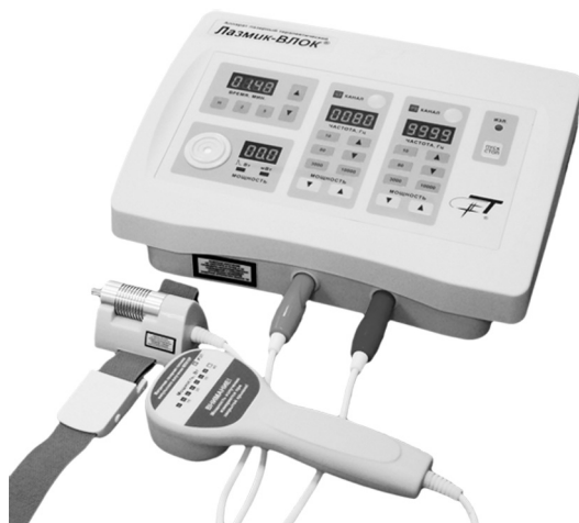
Рис. 1. Аппарат лазерный терапевтический «Лазмик-ВЛОК» с лазерными излучающими головками МЛ-635-40 (внизу справа) и КЛ-ВЛОК-525-20 (внизу слева)
