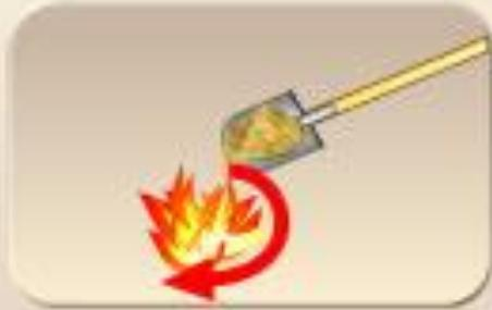
Тушение песком (сухим, сыпучим, без комков) производится путем разбрасывания его по горящей поверхности, этим достигается механическое воздействие на пламя и его частичная изоляция.
