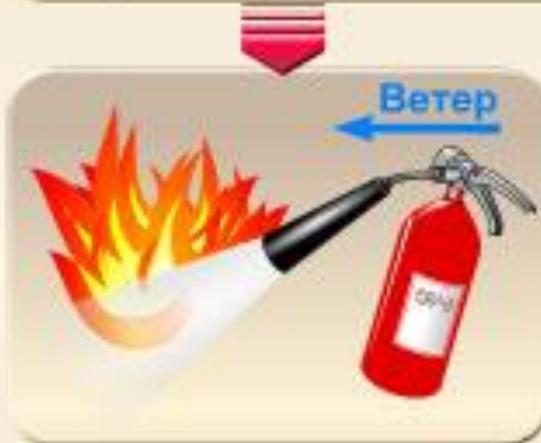
Тушение производить с наветренной стороны при вертикальном положении огнетушителя, переворачивание и наклон огнетушителя более  $45^{\circ}$  не допускается.
