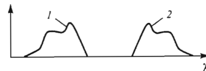
Рис. 3.6. Зеркальное соответствие между спектрами поглощения и спектрами испускания для простых молекул: 1 – поглощение; 2 – флуоресценция
