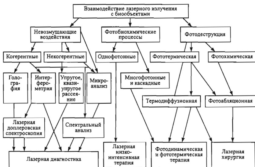
Рис. 4.3. Классификация применения лазеров в медицине, основанная на видах взаимодействия лазерного излучения с биотканями
