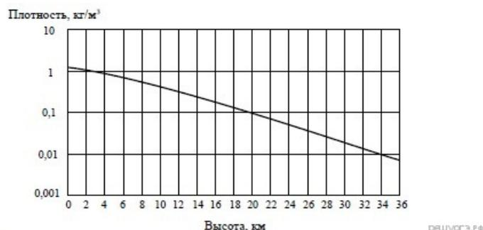
Рис.3 Изменение плотности воздуха с высотой относительно уровня моря
