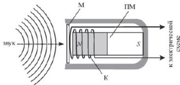
Рисунок. Электродинамический микрофон с подвижной катушкой
