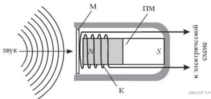
В электродинамическом микрофоне, изображённом на рисунке, подвижную катушку располагают ближе к одному из полюсов постоянного магнита, потому что
