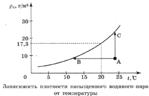
Для возникновения тумана необходимо, чтобы пар стал не просто насыщенным, а пересыщенным. Водяной пар становится насыщенным (и пересыщенным) при достаточном охлаждении (процесс АВ) или в процессе дополнительного испарения воды (процесс АС). Соответственно выпадающий туман называют туманом охлаждения и туманом испарения.
