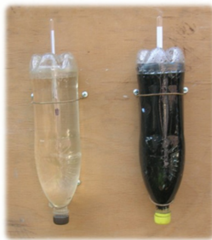
Рис. 11 Установка для исследования влияния отражённой радиации на аккумуляцию солнечной энергии
