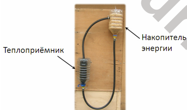
Рис. 18 Установка для накапливания энергии с отдельным теплоприёмником и накопителем
