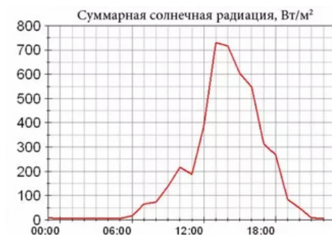
Рис. 2 График зависимости солнечной радиации от времени суток по данным метеостанции в п. Аян Хабаровского края
