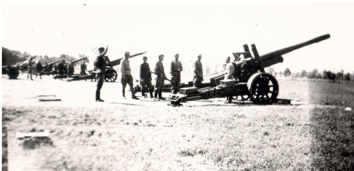
Артиллерийская батарея на основе тяжёлых 152 мм пушек образца 1910/34 гг.
