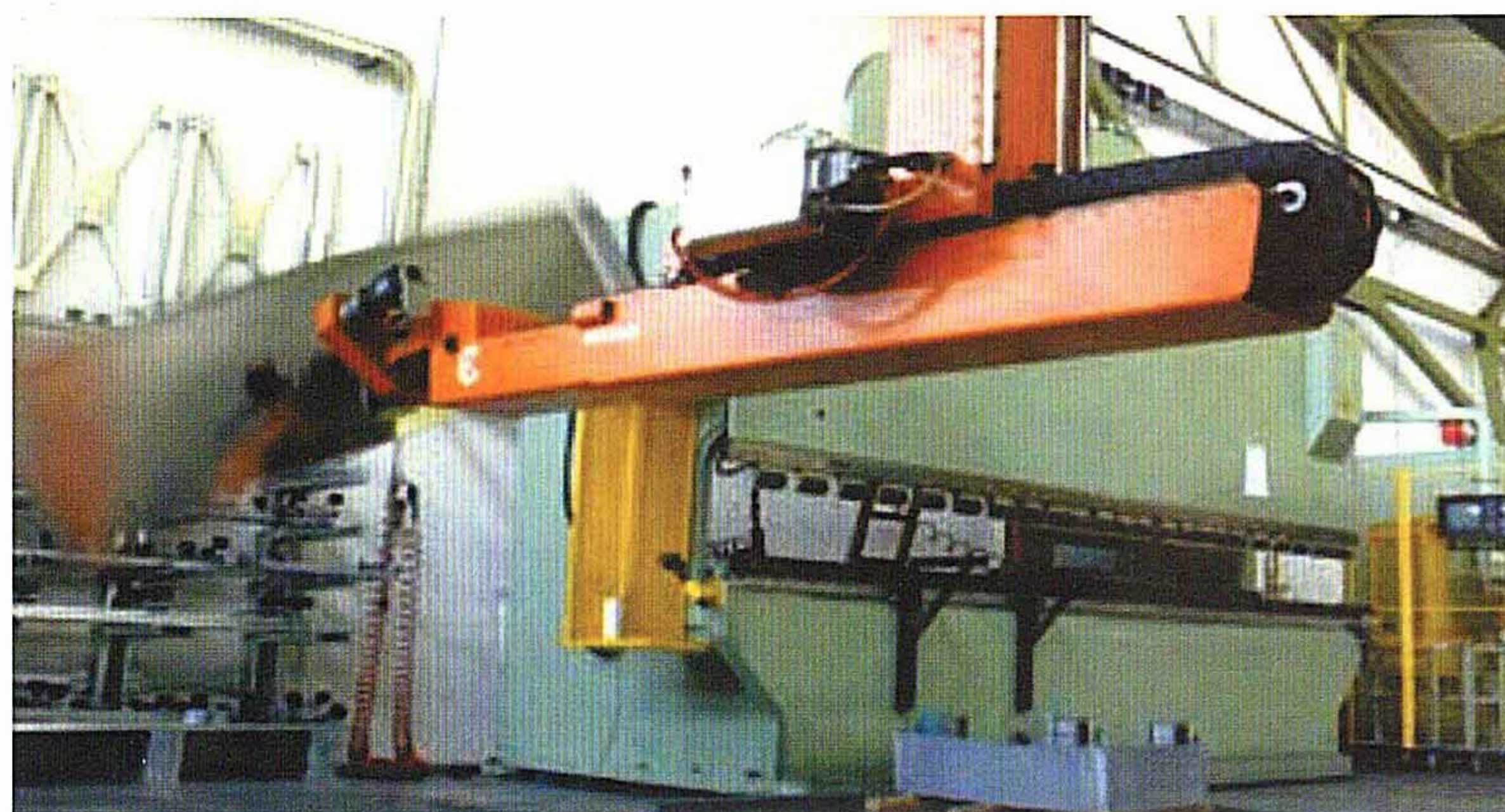
Гибочный робот 5 400 мм 200 тонн
