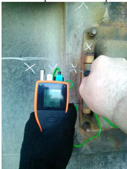
Рисунок 4. Замеры температуры неизолированной и изолированной поверхности (16.03.16) и толщины изоляции в контрольной точке № 3 на участке площадью 0,6 м 2 на высоте обслуживания + 12 360.
