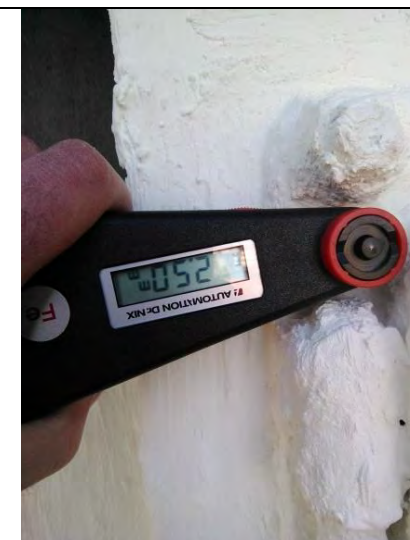
Рисунок 4. Замеры температуры неизолированной и изолированной поверхности (16.03.16) и толщины изоляции в контрольной точке № 3 на участке площадью 0,6 м 2 на высоте обслуживания + 12 360.
