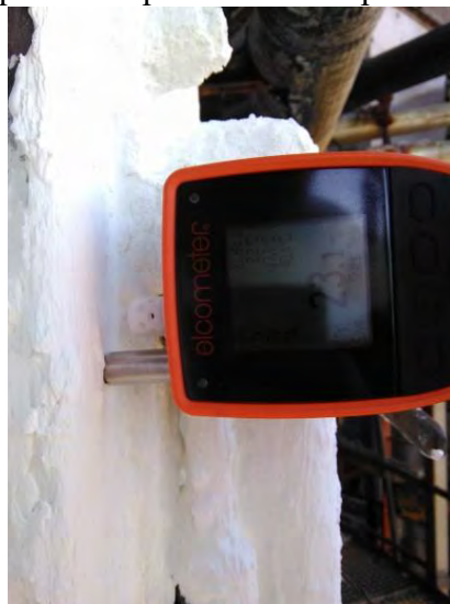
Рисунок 4. Замеры температуры неизолированной и изолированной поверхности (16.03.16) и толщины изоляции в контрольной точке № 3 на участке площадью 0,6 м 2 на высоте обслуживания + 12 360.
