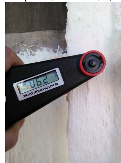
Рисунок 4. Замеры температуры неизолированной и изолированной поверхности (16.03.16) и толщины изоляции в контрольной точке № 3 на участке площадью 0,6 м 2 на высоте обслуживания + 12 360.
